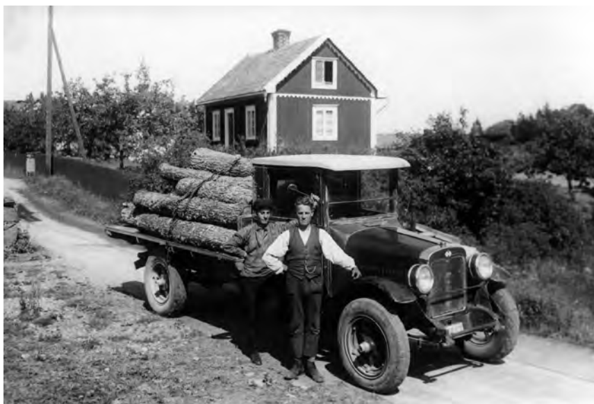
FIGEHOLM Under 1920- och 1930-talen började lastbilar användas för transporter. En typisk lastbil från den tiden kunde vara tillverkad i Tyskland, lasta 3,5 ton, kräva 2,5–3 liter bensin per mil och en liter olja per dag. Foto från 1930. KÄLLA: FIGEHOLMS SJÖFARTSMUSEUM
